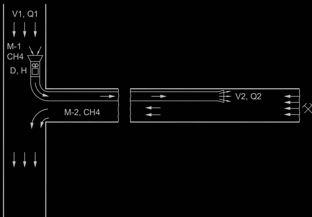
Slika 1: Raspored indikatora za količinu vazduha, depresiju i mjerenje koncentracije CH 4
