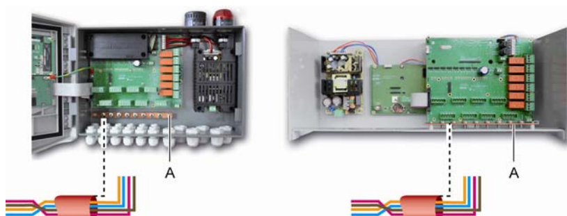
Slika 31: Povezivanje uzemljenja preko šine za uzemljenje.
