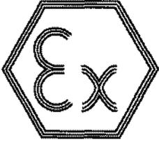
(2) **Appareil ou système de protection destiné à être utilisé en atmosphères explosibles
