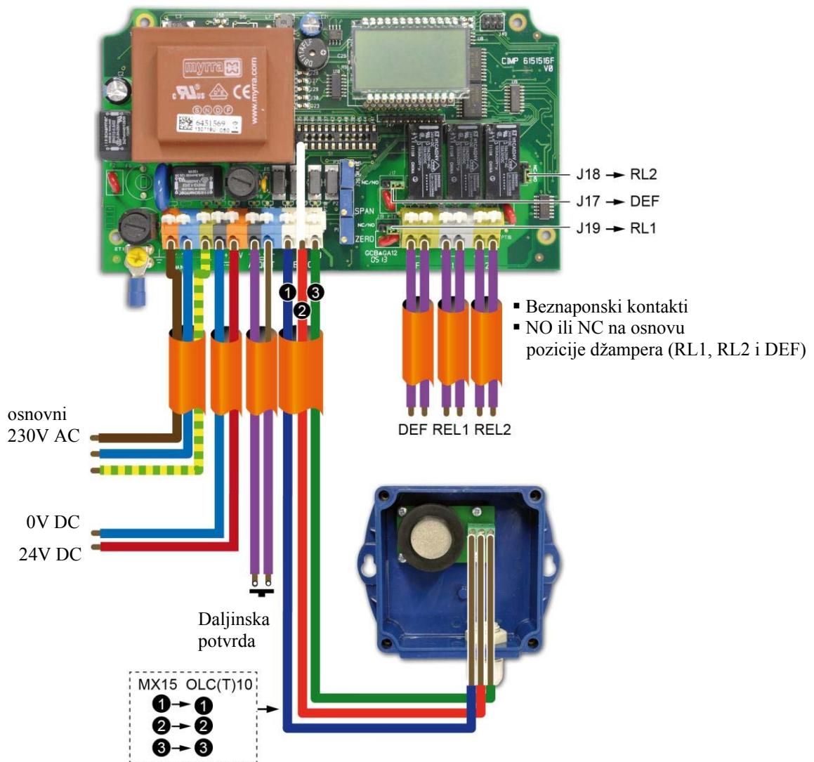
Slika 4 Povezivanje kontrolera MX15 sa Explo ili toksičnim 3 žilnim senzorom
