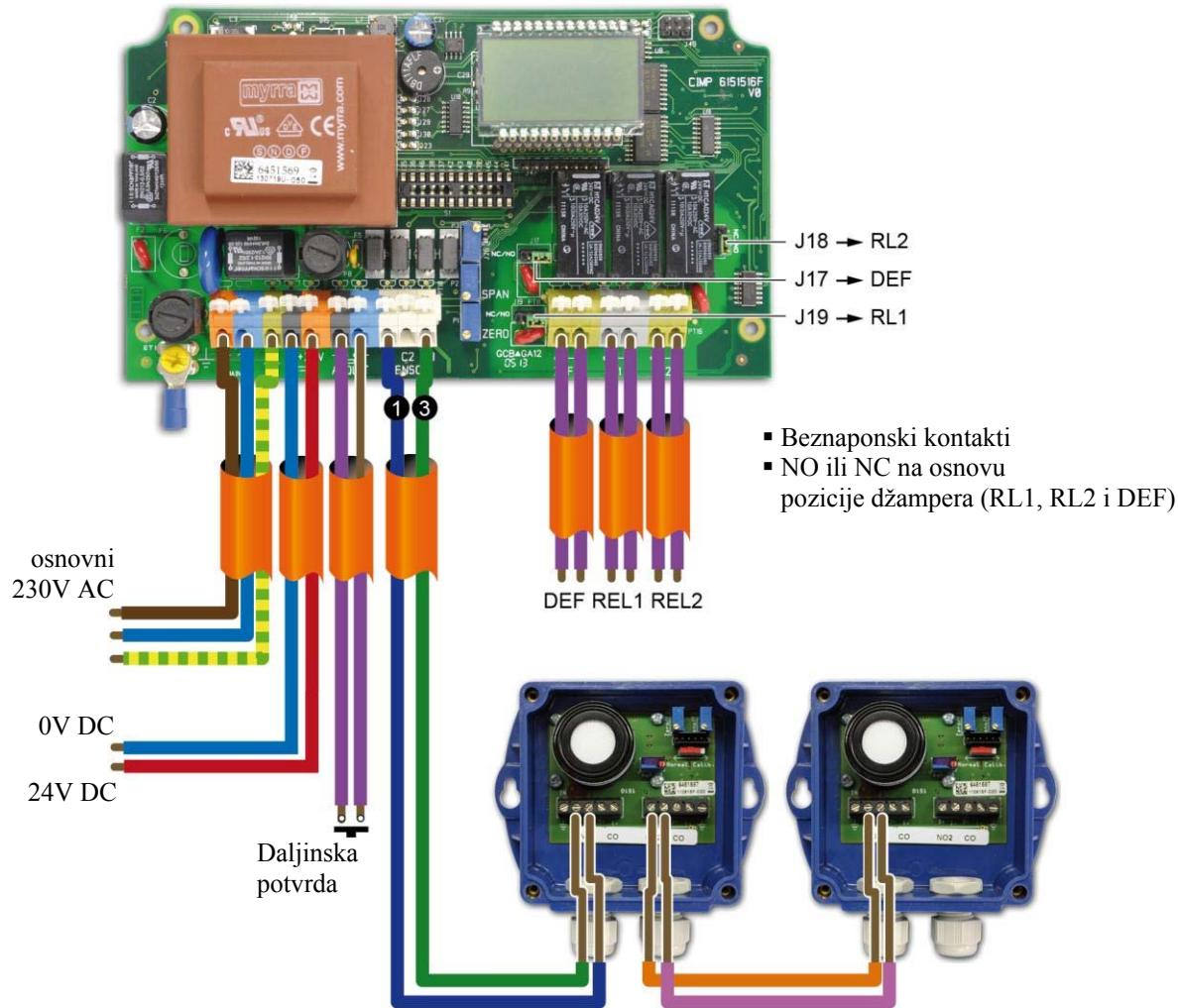
Slika 2 Povezivanja MX15 centralne jedinice i dva OLCT10-tipe senzora za detekciju istog tipa gasa (maksimum 5 senzora).
