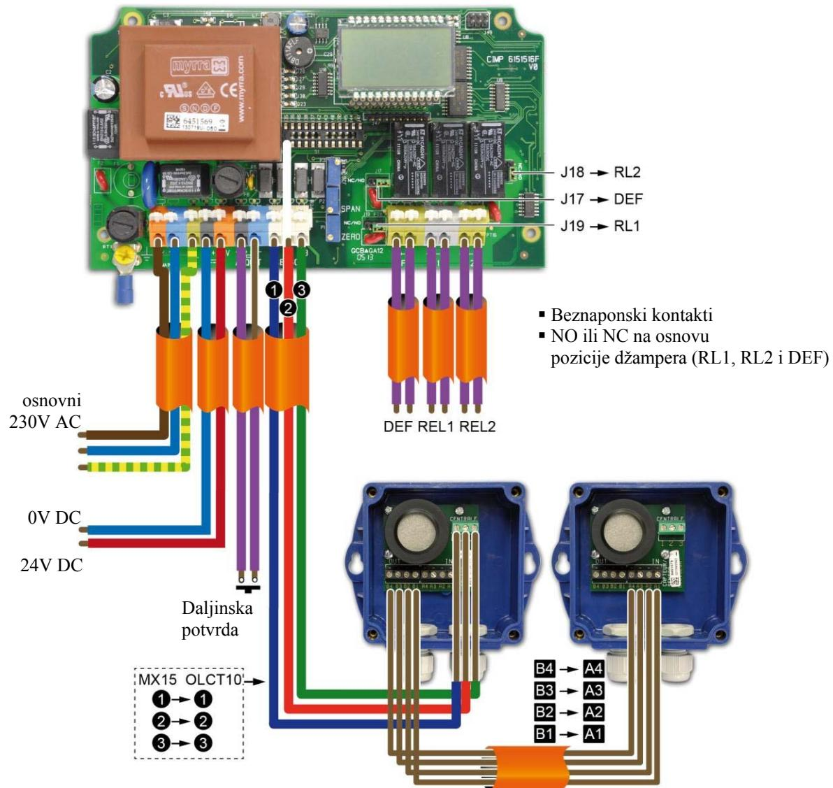
Slika 3 Povezivanje MX15 kontrolera sa dvaOLC 10Twin detektora
