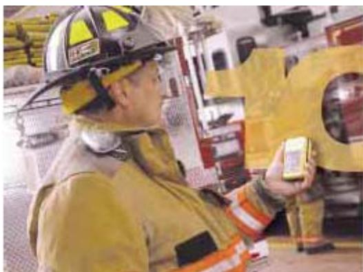
**Vatrogasci i HazMat timovi trebaju biti opremljeni sa prenosnim instrumentima gasne detekcije za merenje i monitoring prisustva gasova i isparenja.**
